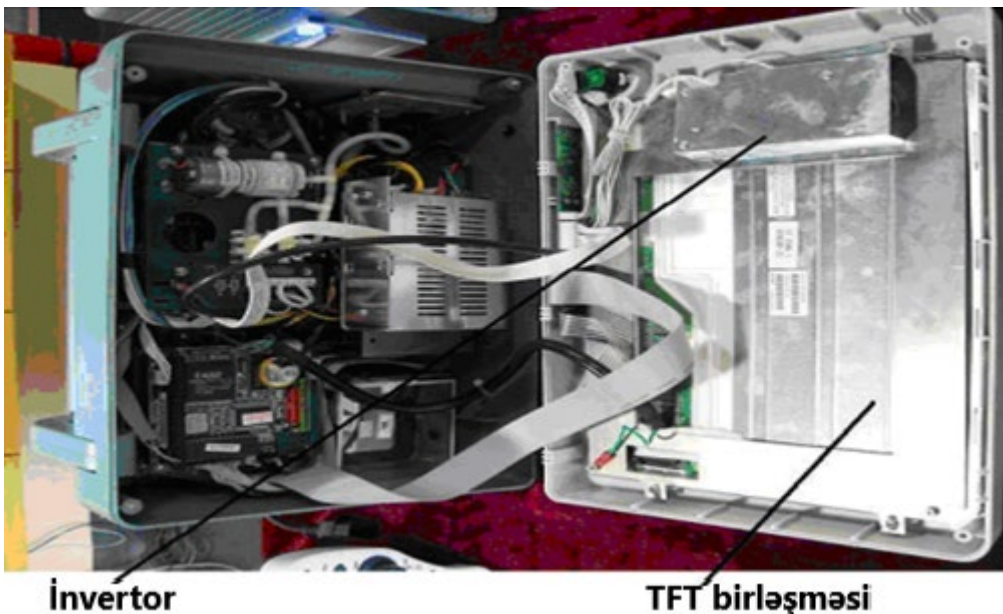
Şəkil 2.33. İnvertor və TFT birləşməsi
