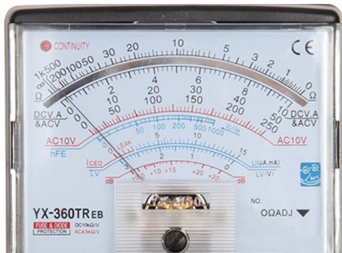
Şəkil 1.17. Analog tester: a) analog testerin ümumi görünüşü, b) analog testerin ölçü şkalası
