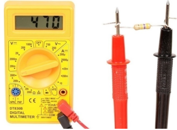
Şəkil 2.6. Rezistorun multimetrlə yoxlanılması
